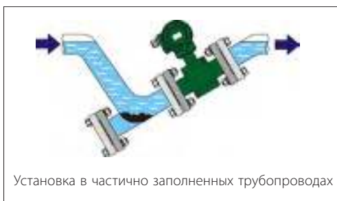
Расходомер устанавливается электронным блоком ВВЕРХ
